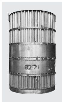
コイル焼鈍用インナーカバー （ステンレス製） （直径2.5m×高さ5.0m）
