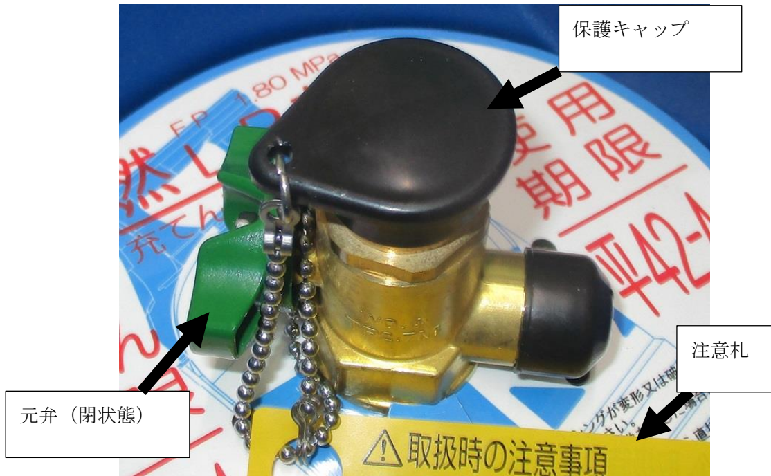
写真2 例 保護キャップ装着状態と元弁閉状態
