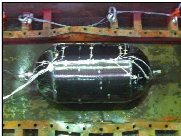
100ℓ蓄圧器（耐圧試験状況）
