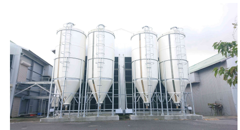
FRP製貯蔵タンク
